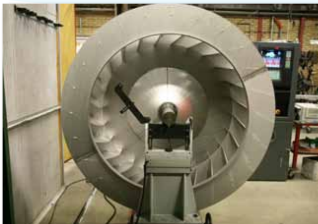
"B hjul" Böjda skovlar med mellanbricka och nav i rostfritt syrafast material.
